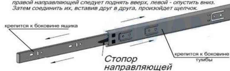
Рис.2 Схема установки шариковых направляющих
